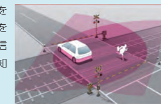
高機能型障害物検知装置(レーザー・レーダー式)
