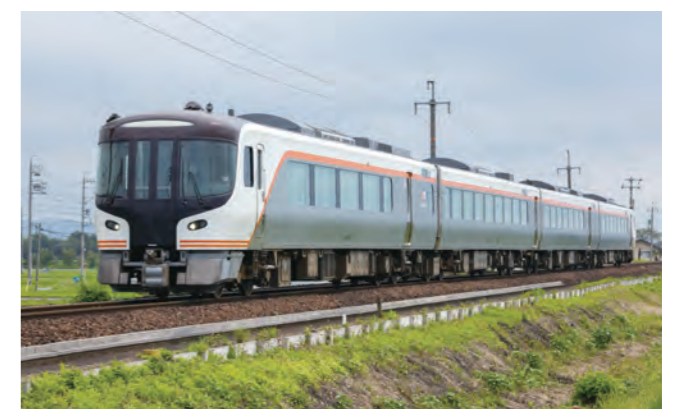
ハイブリッド方式の次期特急車両HC85系(試験走行車)
