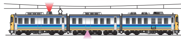
画像認識等を利用して線路や電車線設備の状態をモニタリング
