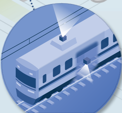
画像認識等を活用して線路や 電車線設備の状態をモニタリング
