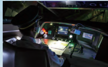
2028年頃に自動運転システム(GoA2)の自動運転機能 ※ を搭載した列車の営業投入を目指し、現在走行試験を行っています ※定時運転機能、定位置停止機能など
