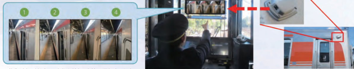
(例)列車に接近した人物を検知、音等で運転士に通知
