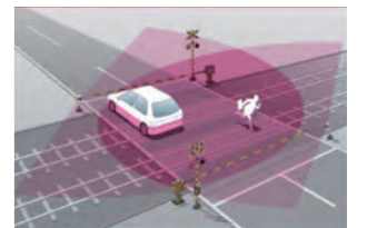
高機能型障害物検知装置(レーザー・センサ式)
