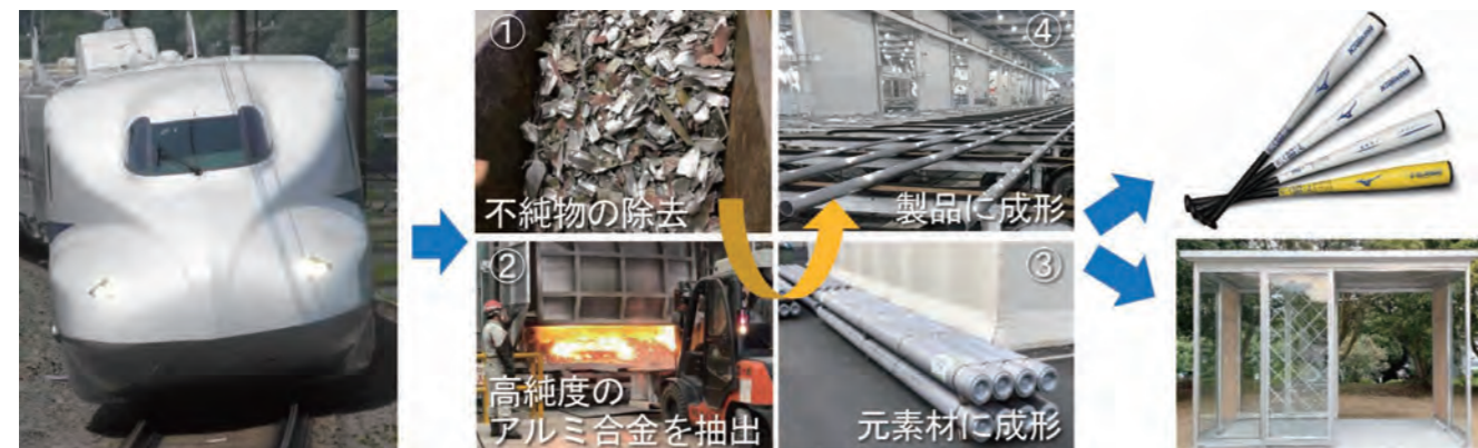
東海道新幹線再生アルミの製造工程・活用例(金属バット・駅舎) ※②、④はSUS株式会社、バット画像はミズノ株式会社提供
